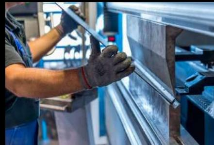
Doblado y prensado de partes y piezas.
